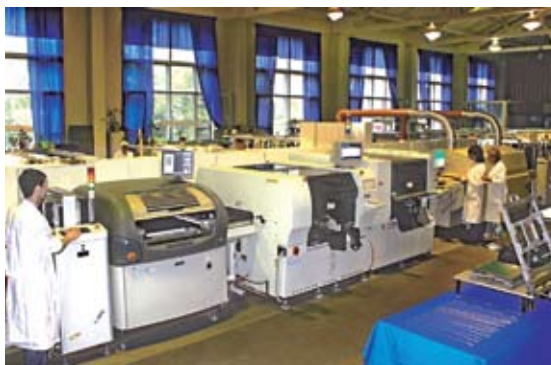
Цех №24. Автоматизированная линия поверхностного монтажа печатных плат
