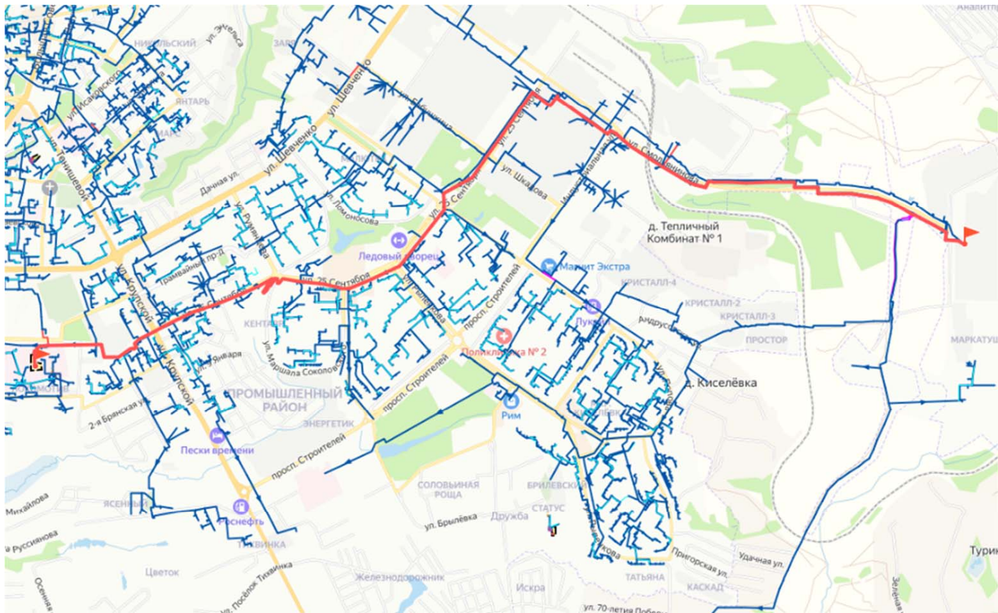
Рисунок 4.1 – Путь пьезометрического графика для участка теплосети от «Смоленской ТЭЦ-2» до перспективной застройки Областной детской клинической больницы
