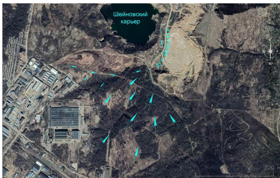
Рис. 2.2. Схема отведения поверхностного стока на прилегающей территории.
