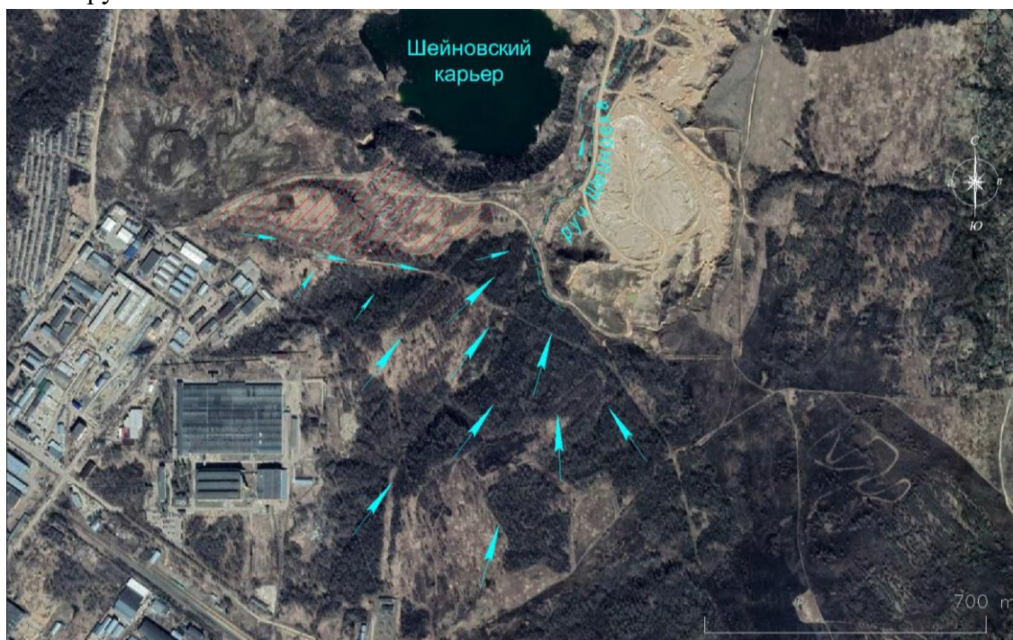
Рис. 2. Схема отведения поверхностного стока на прилегающей территории Для отведения дождевых вод и фильтрата, образующегося в период строительно-монтажных работ, предусматривается устройство временной водоотводящей канавы. Временная водоотводящая канава устраивается только в границах выделенных земельных участков после уборки отходов. Вынимаемый при отрывке канавы минеральный грунт складывается в отвал в виде земляного вала трапецевидной формы, который препятствует
