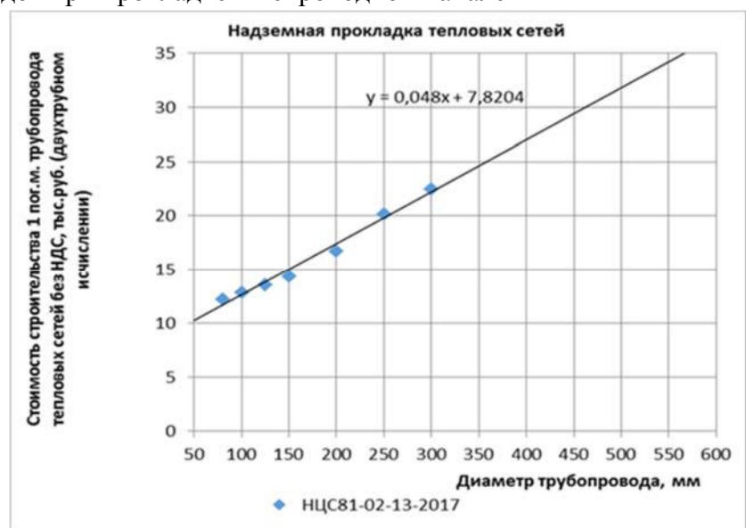
Рисунок 9.3 – Зависимость стоимости строительства трубопроводов тепловых сетей от диаметра трубопроводов при надземной прокладке на низких опорах
