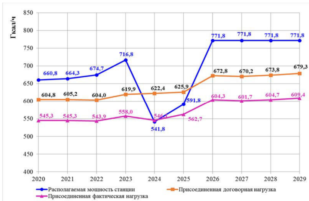
Рисунок 7.1 – График обеспеченности покрытия присоединенных тепловых нагрузок
