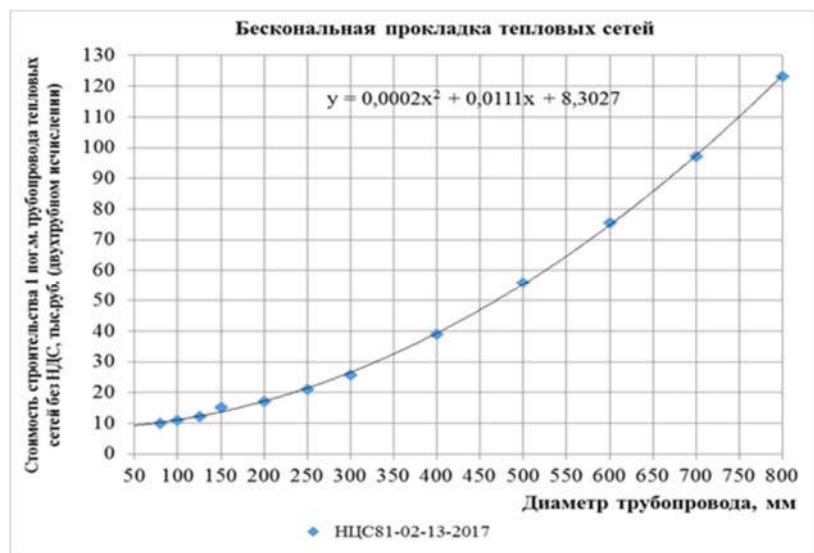
Рисунок 9.1 – Зависимость стоимости строительства трубопроводов тепловых сетей от диаметра трубопроводов при бесканальной прокладке
